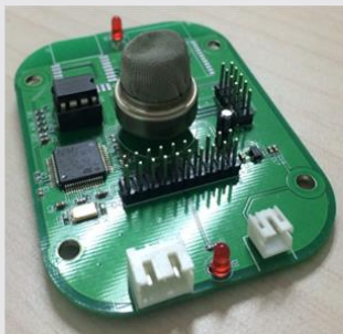
带国密算法传感器节点，SM1-2-3和ZUC接入，图为气体传感器
