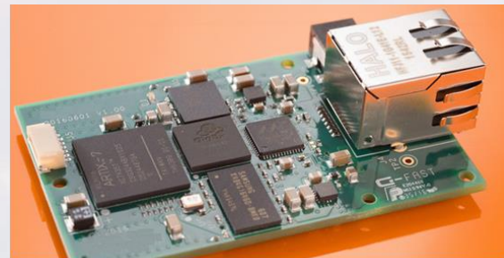
网络加密模块，FPGA及高速并行密码运算。
